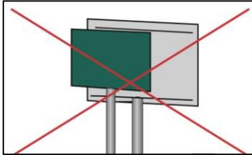
Lorsqu'il pourra être implanté un panneau double face, les deux faces devront être d'une surface identique.
