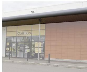
Avancée en matériaux durs en saillie sur un mur, au-dessus d'une ouverture ou d'une devanture dont l'objet est de protéger des intempéries.
