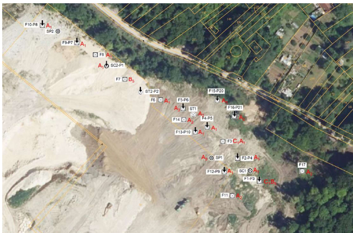
Répartition des classes GTR sur les couches superficielles des sondages – talus Nord
