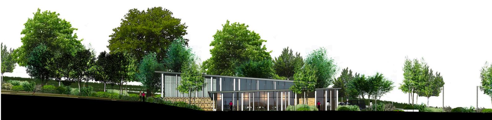
Chacune des lames a une hauteur de toiture différente, ce qui permet de détacher chaque volume l'un de l'autre et fragmenter le bâtiment selon la topographie du terrain.
